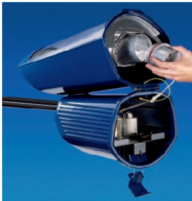
El elemento que contiene el bloque óptico está sujeto por una bisagra. Se accede a la lámpara mediante rotación de un cuarto de vuelta del soporte-portalámparas.
